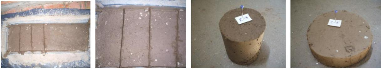
Para utilizarlo, se tomó 0,56 kg (aprox. 0,0003519 m<sup>3</sup>) de éste material conformando 1 parte y se mezcló con 3 partes de arena, agregándole aproximadamente 1 ¼ parte de agua y mezclado. La mezcla se desplegó sobre una pared de ladrillos por medio de una llana, “planchándolo” en una capa de aprox. entre 2 y 4 mm, con un rendimiento de 0,30 m<sup>2</sup>.
