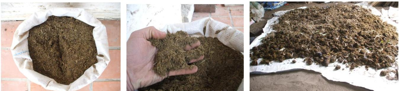
Este material se obtiene de caballerizas, se seca al sol donde se aprovecha a limpiarlo de piedras o elementos que no constituyan fibra y se lo somete a un proceso de molienda. Posteriormente se embolsa x 8 kg. Esta unidad de envasado, para ser utilizado en mezclas para revoque fino tiene un rendimiento de 45 m<sup>2</sup>.
