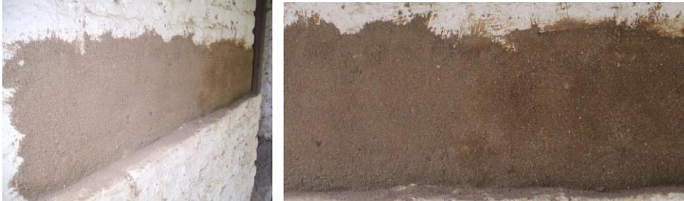
De los datos de prueba se establece que para 1 m<sup>2</sup> de revoque fino es necesario 1,86 kg de base arcilla/fibra.
