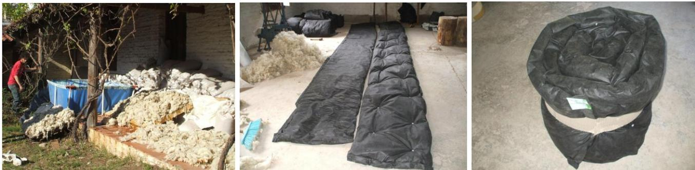
Con el material tratado se comienza las tareas de escardado manual y se arman unos paneles de 0,60 por longitudes variables (de 4 a 8 mts), de aproximadamente 50 a 60 mm de espesor. Se aporta 700 grs por m2 para garantizar una adecuada capacidad aislante.
